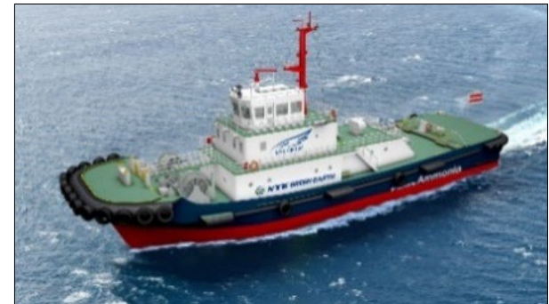
アンモニア燃料船タグボート（イメージ） 日本郵船株式会社 提供
